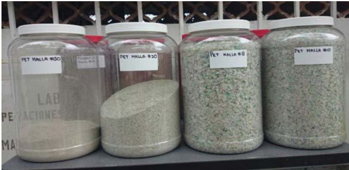
Figura 7. Envases con diferentes triturados de hojuelas de PET clasificadas en el laboratorio de Operaciones Unitarias de la Facultad de Ciencias Químicas de la Universidad Veracruzana
