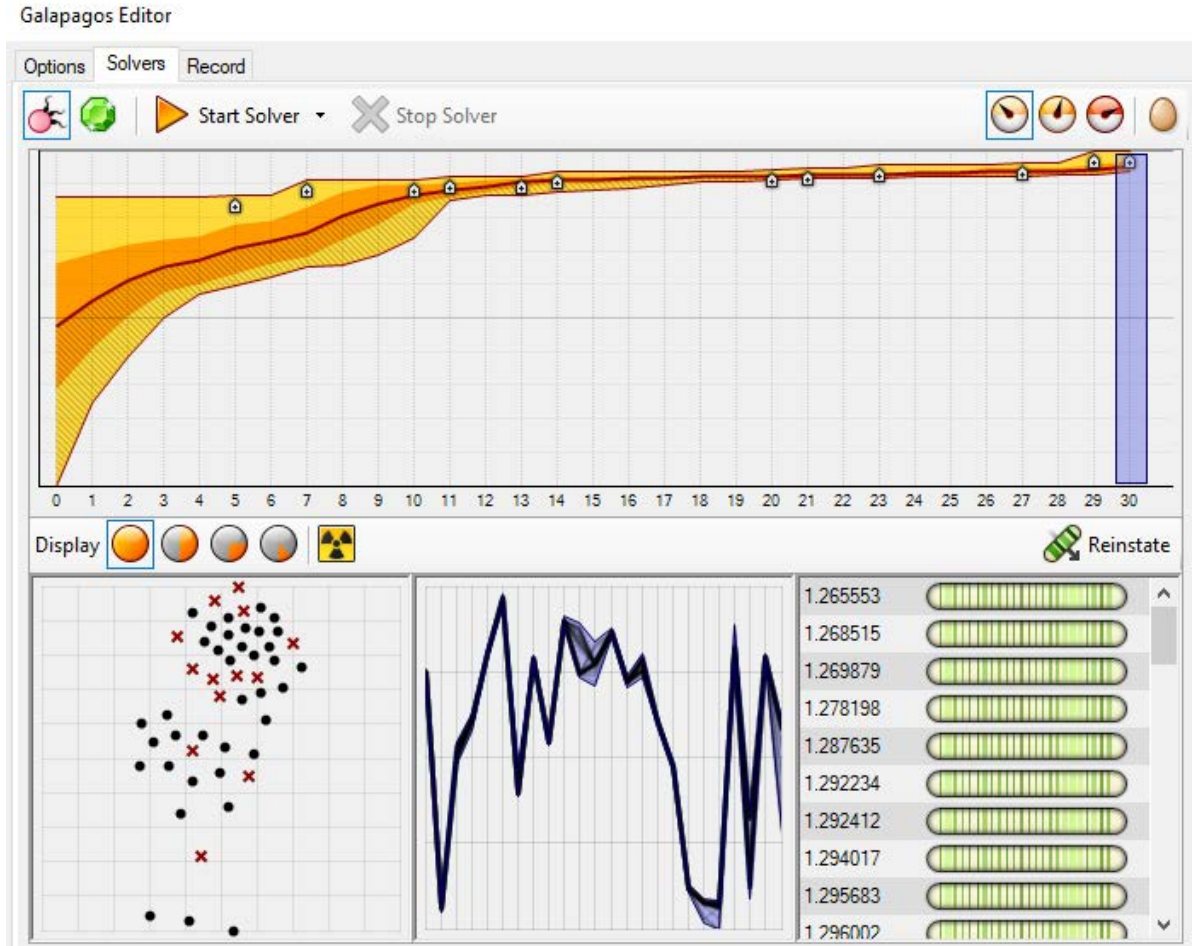
Figura 2. Modelo 1. Visualización de resultados generados por un algoritmo genético para optimizar combinaciones formales y maximizar la eficiencia energética del modelo
