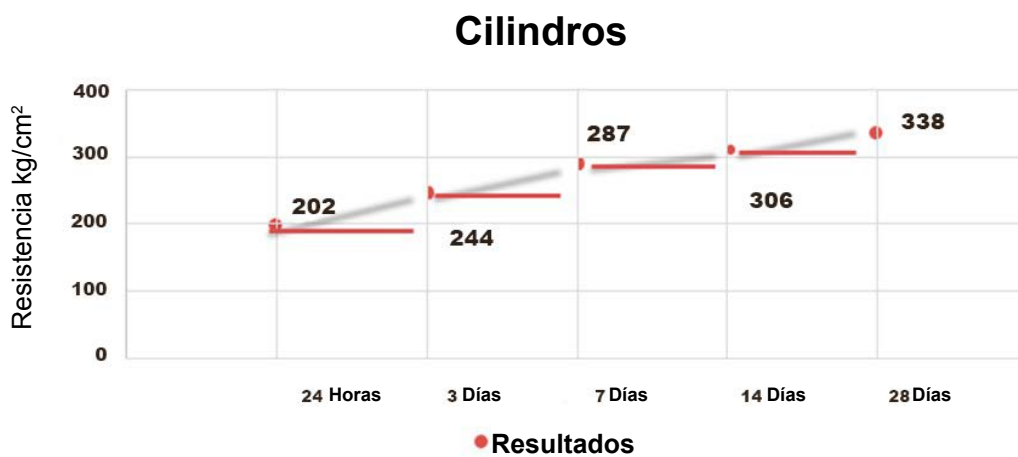
Figura 14. Resistencia obtenida de la mezcla diseñada con cilindros
