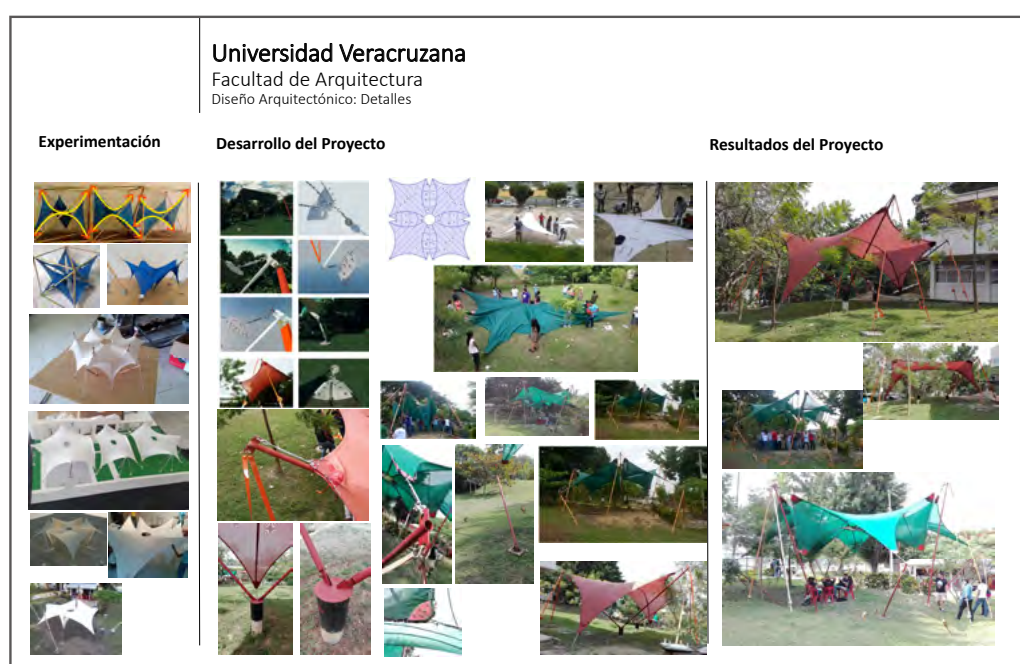
Figura 11. Propuesta de cubiertas ligeras: cubierta bidireccional plegable.
