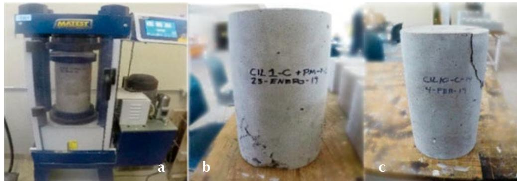
Figura 3. a) Prensa; b) Mezcla de polvo de mármol; c) Mezcla normal.
