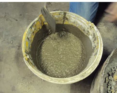
Figura 9. Vertido del agregado fino en la suspensión mecánica. Fuente: elaboración propia (2019). CC BY
