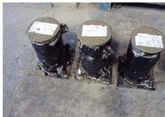
Figura 11. Probetas cilíndricas de 10 x 20 cm (MSM). Fuente: elaboración propia (2019). CC BY
