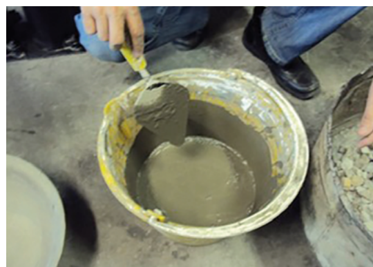
Figura 8. Mezcla del cemento con el agua: suspensión mecánica. Fuente: elaboración propia (2019). CC BY
