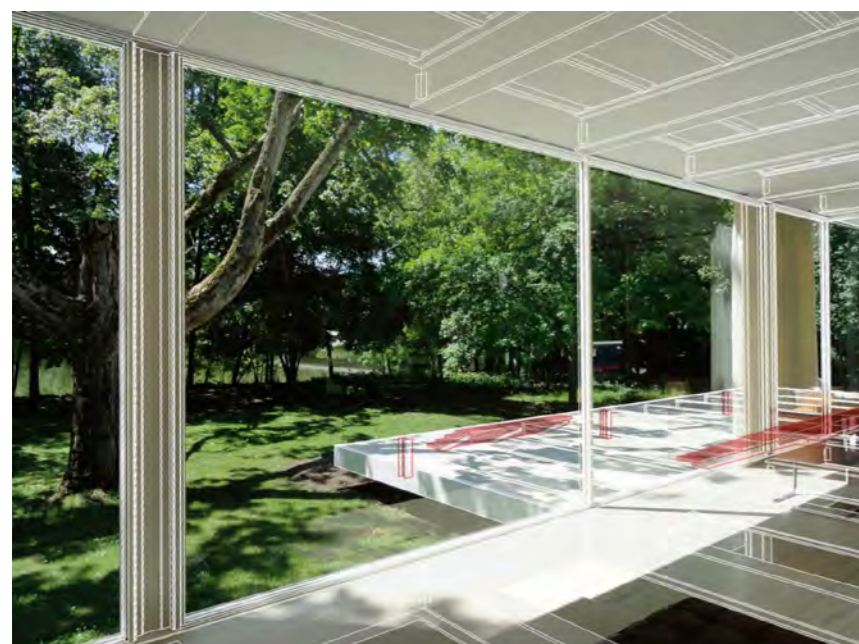
Figura 9. Esquema tridimensional que muestra la estructura y el sistema de evacuación de aguas lluvias Fuente: elaboración propia, 2011. CC BY-ND
