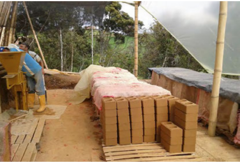
Figuras 4 y 5. Planta de producción in situ, almacenamiento y curado de BSC en obra Fuente: Carlos Mauricio Bedoya y Jorge Moreno, 2014.
