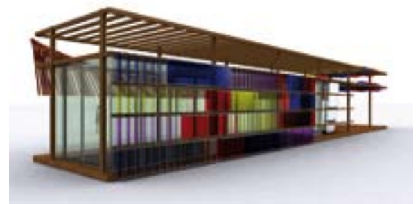
▲ Figura 7 Aplicaciones arquitectónicas del grupo de investigación del sistema de láminas articuladas en fachadas móviles que controlan el paso de viento y luz.
