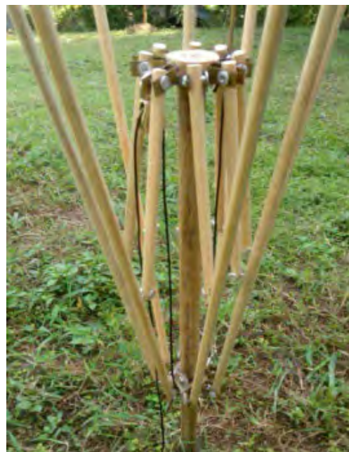
▲ Figura 10. Se agregó un sistema de polea para tener la propiedad de plegado
