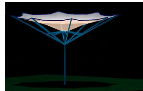
Figura 13. Después de generarse la estructura completa junto con la membrana se obtiene mayor estabilidad
