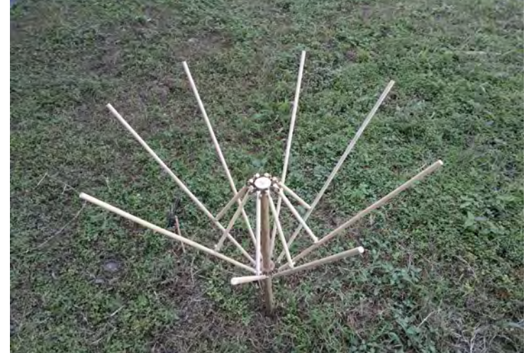
▲ Figura 9. Mejoramiento del modelo experimental; al agregarle ocho miembros mantiene un mejor equilibrio estructural
