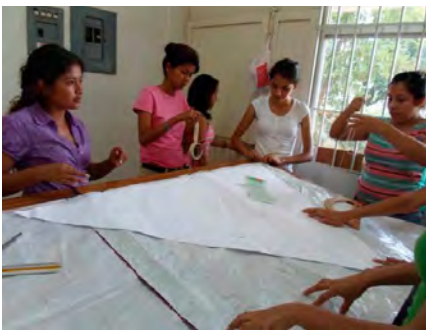
Figura 20. El patronaje de la velaría es sumamente importante, ya que el manto servirá como rigidizador del sistema y, por ello, debe tener una superficie exacta, para que posteriormente pueda ser tensada en el paraguas Fuente: Morales (2013b).
