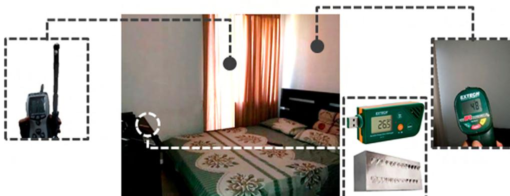
Figura 3. Esquema explicativo de la instalación del instrumental en el interior del dormitorio monitoreado. Fuente: elaboración propia (2019).
