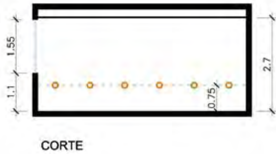
Figura 5. Planta baixa e corte com indicação da malha de pontos de medição para o ambiente modelo Fonte: Os autores.
