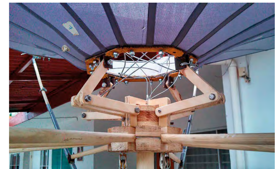
Figuras 4 a 7. El modelado del paraguas retráctil ayudó a generar detalles constructivos más exactos para su funcionamiento al desplegado Fuente: Morales (2012; 2016, fig. 16).
