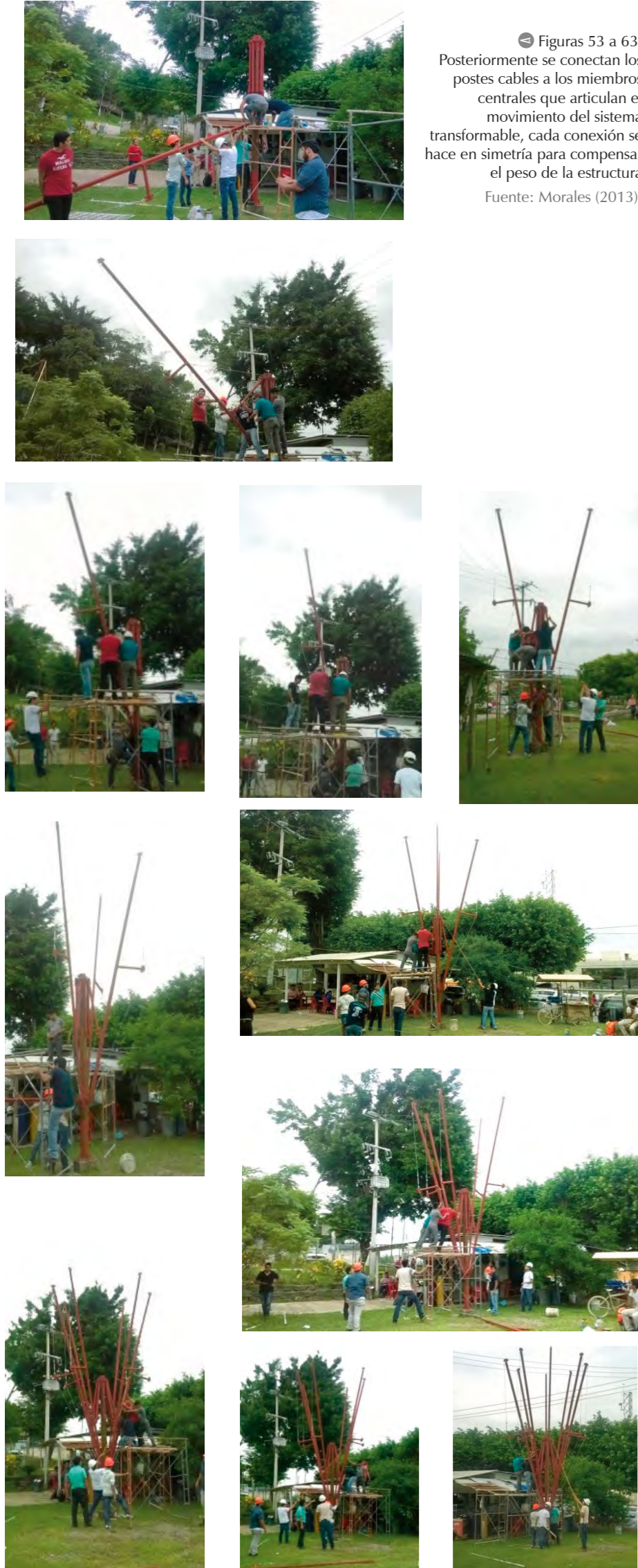
Figuras 64 a 66. Se realizó una prueba de movilidad de los brazos principales sin membrana, esto para probar la resistencia de los malacates y la velocidad en la cual se debería tener la resistencia adecuada a la hora de desplegar el sistema transformable Fuente: Morales (2013).
