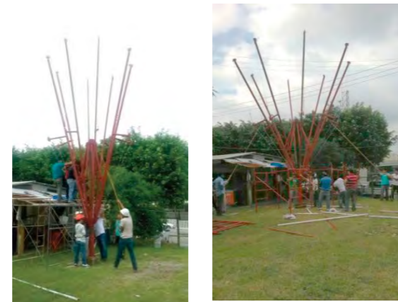
Figuras 64 a 66. Se realizó una prueba de movilidad de los brazos principales sin membrana, esto para probar la resistencia de los malacates y la velocidad en la cual se debería tener la resistencia adecuada a la hora de desplegar el sistema transformable Fuente: Morales (2013).
