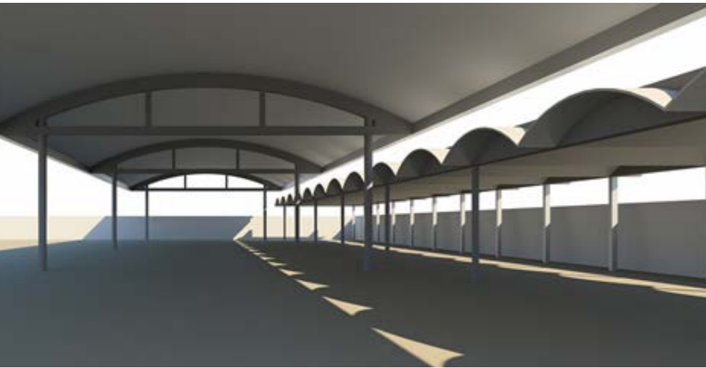
Figura 10. Reconstrucción digital del sistema de cubierta del edificio [d], en primer plano, y del edificio [e] a la derecha Fuente: Laura Henao, 2018, CC BY.
