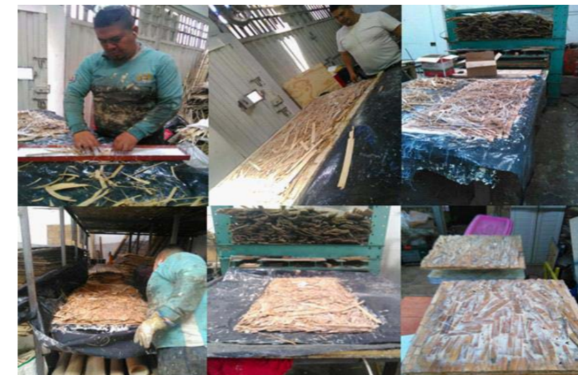
Figura 7. Proceso de fabricación del tablero OSB, empresa MuisKay Fuente: elaboración propia, 2017, CC BY-ND.
