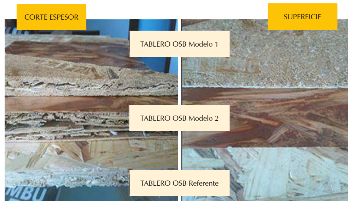
Figura 14. Composición de los tableros OSB del referente y las propuestas 1 y 2 Fuente: elaboración propia, 2017, CC BY.
