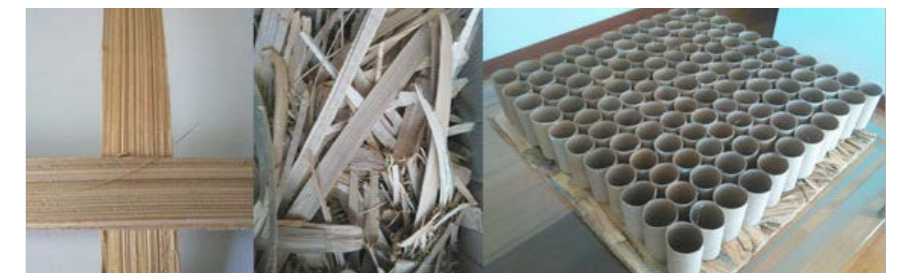
Figura 6. Fibra de guadua reciclada y tubos de cartón reciclados Fuente: elaboración propia, 2017, CC BY-ND.
