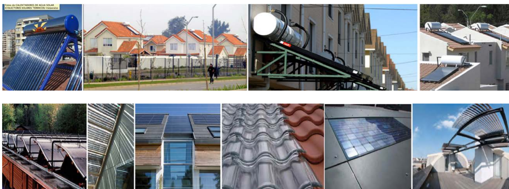
Figura 7. Colectores solares térmicos sobrepuestos (imágenes superiores) e integrados (imágenes inferiores) Fuente: IEA y SHC Task 41 (2012a).
