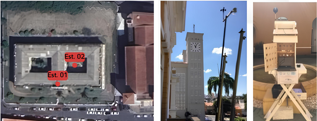
Figura 3. Posicionamento das estações meteorológicas na cobertura do edifício (Est. 01) e no pátio da ala direita (Est. 02), selecionado para a calibração do modelo computacional e para as simulações com inserção das paredes verdes
